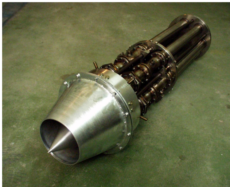
Рисунок 2.2 – Многотрубный импульсный детонационный двигатель
